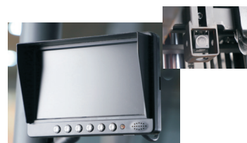
摄像头和LCD显示屏为可选装置，可以使操作者在高点操作时更加准确到位
